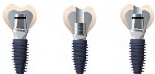
그림 3. 임플란트 보철의 유지 형태 - Cement retained type, Screw retained type, SCRП type.
