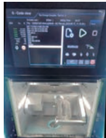
그림 13. PMMA Abutment의 밀링이 완료된 모습. 상악중절치 한 개 밀링에 8분47초가 소요되었다.
